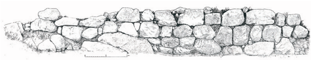
64. Corral d'en Pi. Un altre exemple d' opus siliceum arcaïtzant el documentem en aquesta construcció relacionada amb l'espai portuari de Riells - la Clota (baixa república). (Dibuix a partir de Ripoll i Llongueras, 1974)
