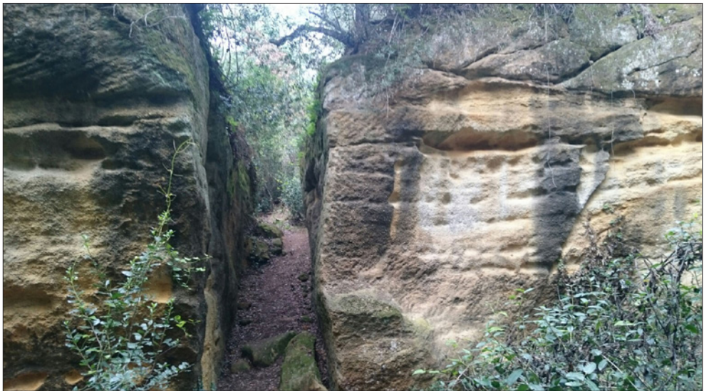
50. Clots de Sant Julià. Al centre de la imatge, passadís de circulació per extreure blocs, amb els fronts de tall als costats.
