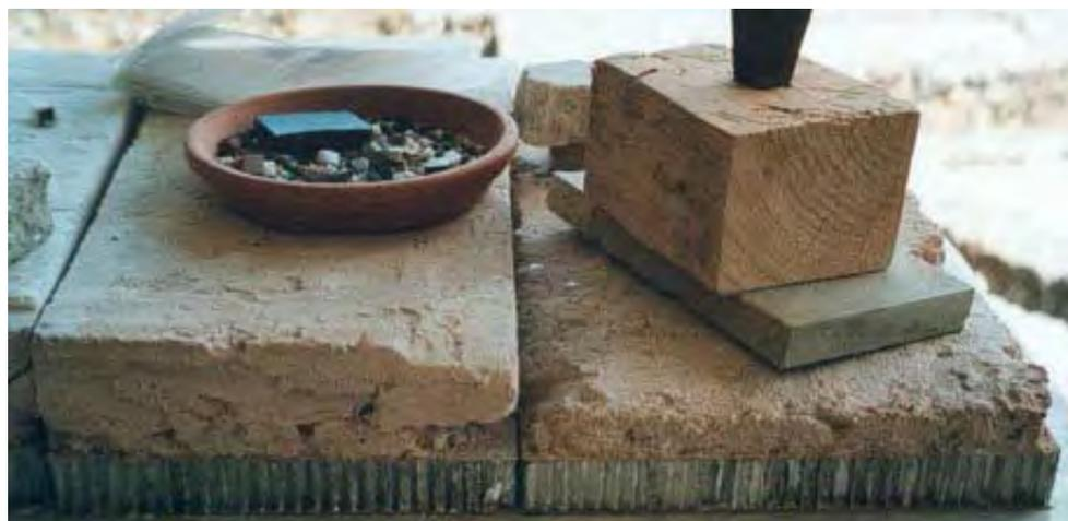
Figure 14. *Villa* de Montcaret : coupe d'une mosaïque restaurée puis déposée sur un sandwich stratifié (réalisation entreprise SOCRA) (R. Dupont).
