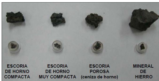
Figura 6. Tipos de escorias identificados en el sector metalúrgico.
